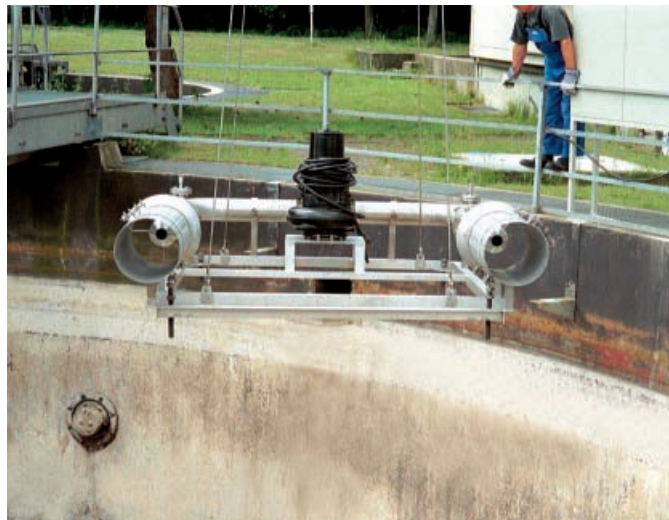
2 einstrahlige Ejektoren mit Tauchmotorpumpe auf einem gemeinsamen Grundrahmen
