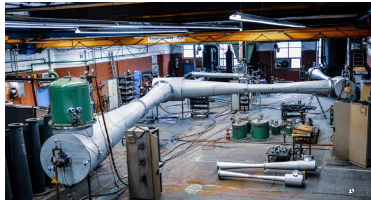
Dreistufige Dampfstrahl-Vakuumpumpe auf dem Körting Leistungsprüfstand
