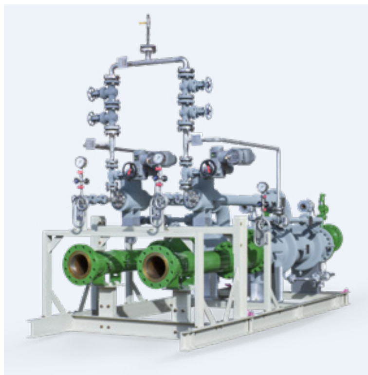
Zweistufige Turbinenentlüftung in redundanter Ausführung mit Instrumenten, Absperrarmaturen und Treibdampfleitungen
