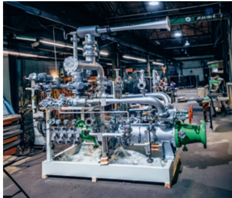
Zweistufige Turbinenkondensatorentlüftung in redundanter Ausführung der Strahlpumpen sowie Anfahrstrahlpumpe, Schalldämpfer, Instrumente, Absperrarmaturen, Prozess- und Treibdampfleitungen
