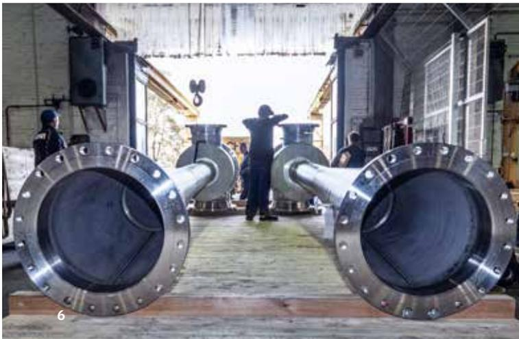
Regelbarer Dampfstrahl-Kompressor mit Düsennadelsteuerung im Werk Hannover
