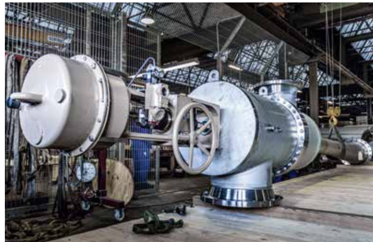
Regelbarer Dampfstrahl-Kompressor mit Düsennadelsteuerung im Werk Hannover
