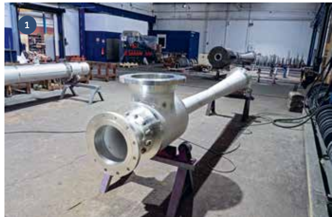
1/2/3) Dampfstrahl-Kompressoren im Prüffeld
