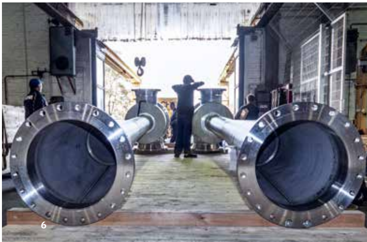
Körting Dampfstrahl-Kompressoren bei der Verladung
