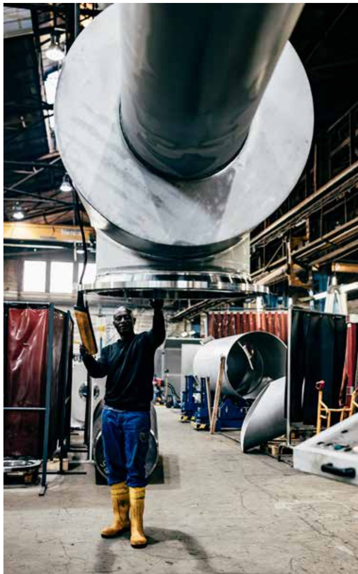
Dampfstrahlpumpe in der Fertigung in Hannover
