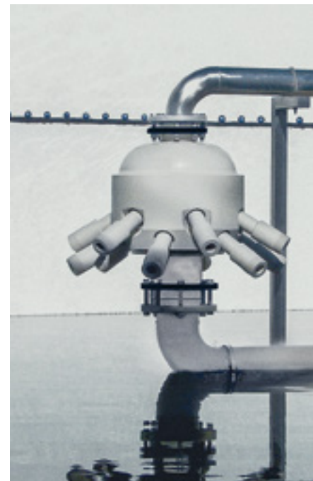
zwölfstrahliger Ejektor aus PP
