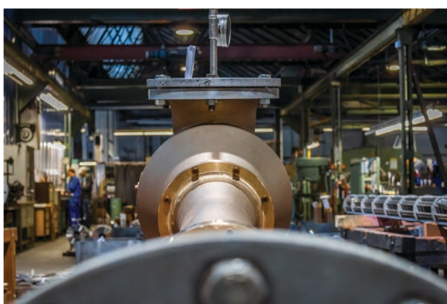
Струйный эжектор с производительностью по всасыванию более 500 куб метров в час.
