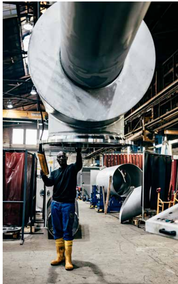
Dampfstrahlpumpe in der Fertigung in Hannover
